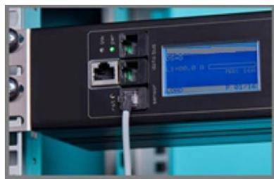
Le PDU a un port pour capteurs pour connecter un capteur de température numérique, un contact d'interrupteur sec ou un capteur combiné pour la température/l'humidité. Le PDU enregistre quel capteur est connecté et adapte automatiquement le menu à l'écran en fonction du/des capteur(s) détecté(s).
