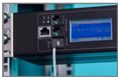
Die PDU hat einen Sensor-Anschluss für die Verbindung eines digitalen Temperatursensors, eines Trockenschaltkontakte oder eines kombinierten Sensors für Temperatur/Feuchtigkeit. Die PDU stellt fest, welcher Sensor verbunden ist und passt das Menü am Display automatisch an den/die Sensor(en) an, den/die sie erfasst hat.
