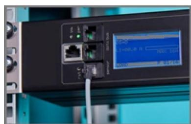
Блок распределения электропитания оснащается портом для подключения цифрового датчика температуры, одного датчика типа «сухой контакт» или комбинированного датчика температуры/влажности. Блок распределения электропитания регистрирует подключенный датчик и автоматически адаптирует меню на экране к типу обнаруженного датчика (датчиков).
